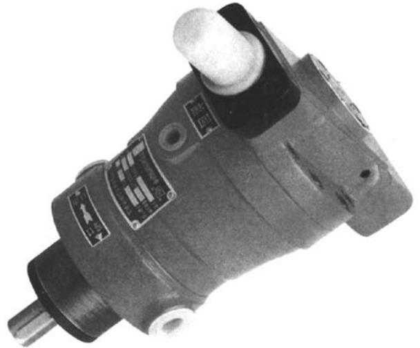
本变量机构的泵是依靠内控油压操纵变量机构，泵的压力调节范围比较小，油泵在3~5Mpa时产生变量后，流量迅速减小至所要求的高压流量值。
